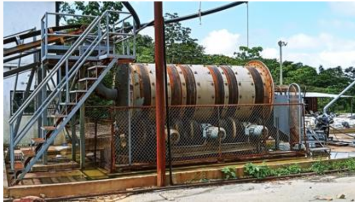
Figura 6. Molino de bolas
