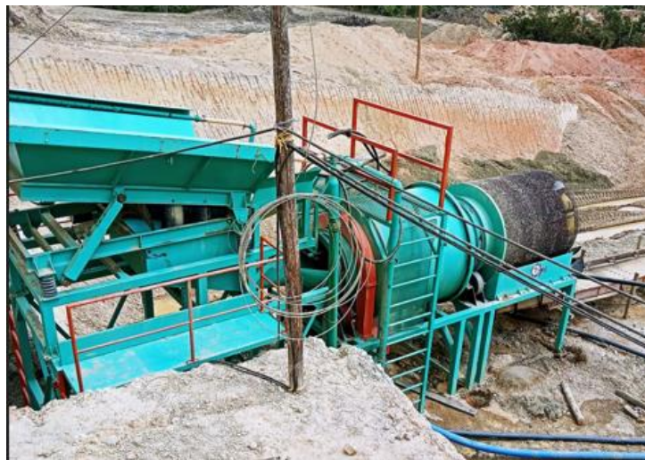
Figura 8. Sistema de criba vibratoria y trommel
