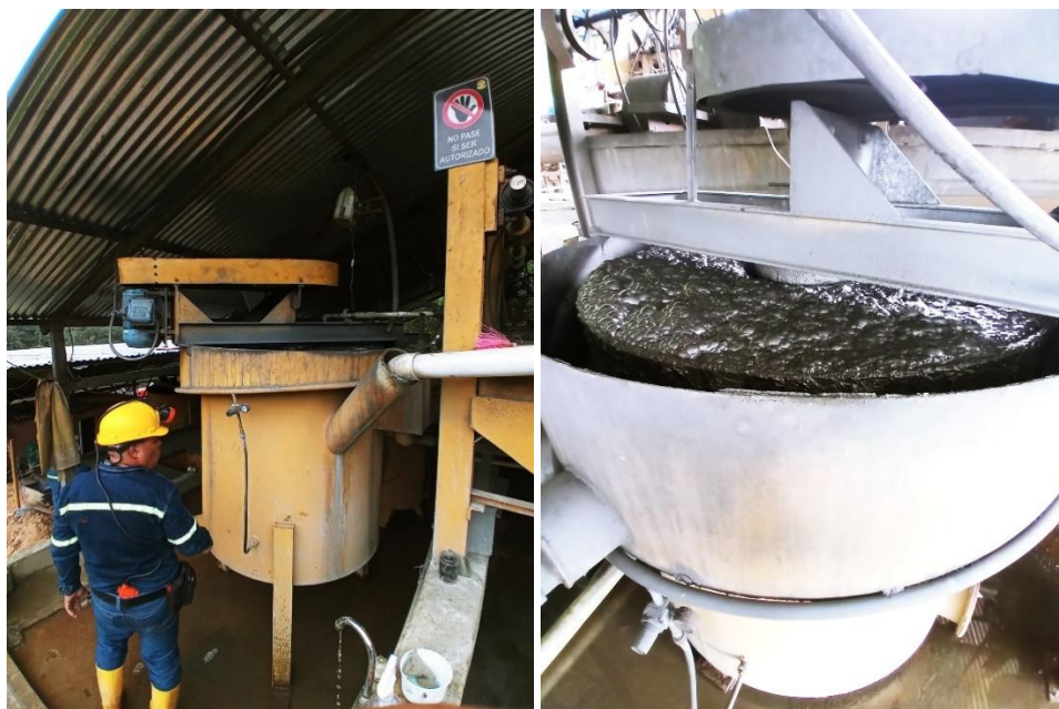
Figura 11. Celda de flotación en funcionamiento
