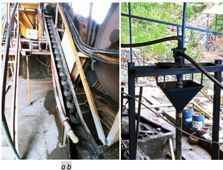
Figura 9. Equipos de clasificación en fluido. a. Un clasificador de espiral y b. un hidrociclón Fuente: © Archivo del Grupo de investigación Observatorio IGNEA – Universidad Nacional de Colombia.
