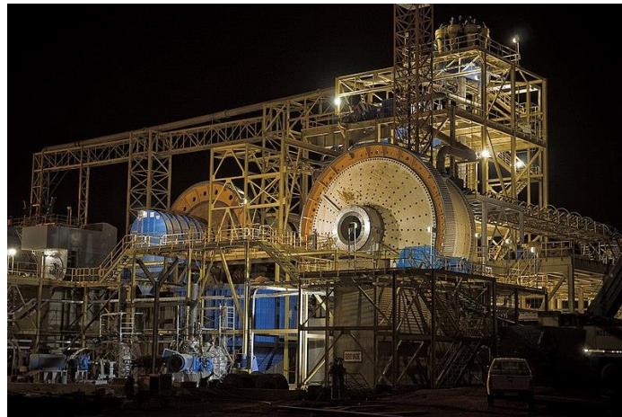
Figura 7. Molino autógeno
