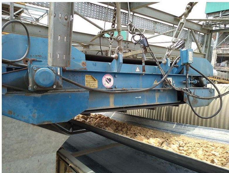
Figura 12. Separador magnético de banda cruzada Fuente: Fachab (2019).
