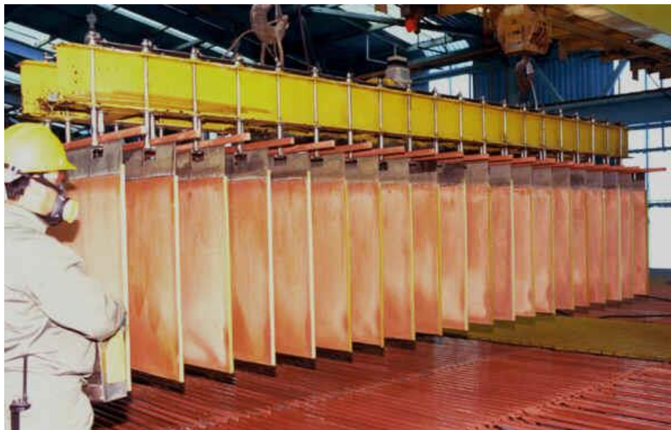
Figura 17. Proceso de electroobtención en el procesamiento de cobre
