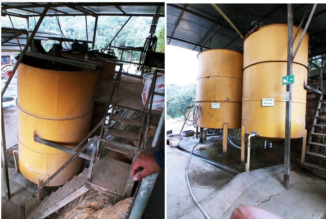
Figura 13. Tanques para lixiviación por agitación mecánica
